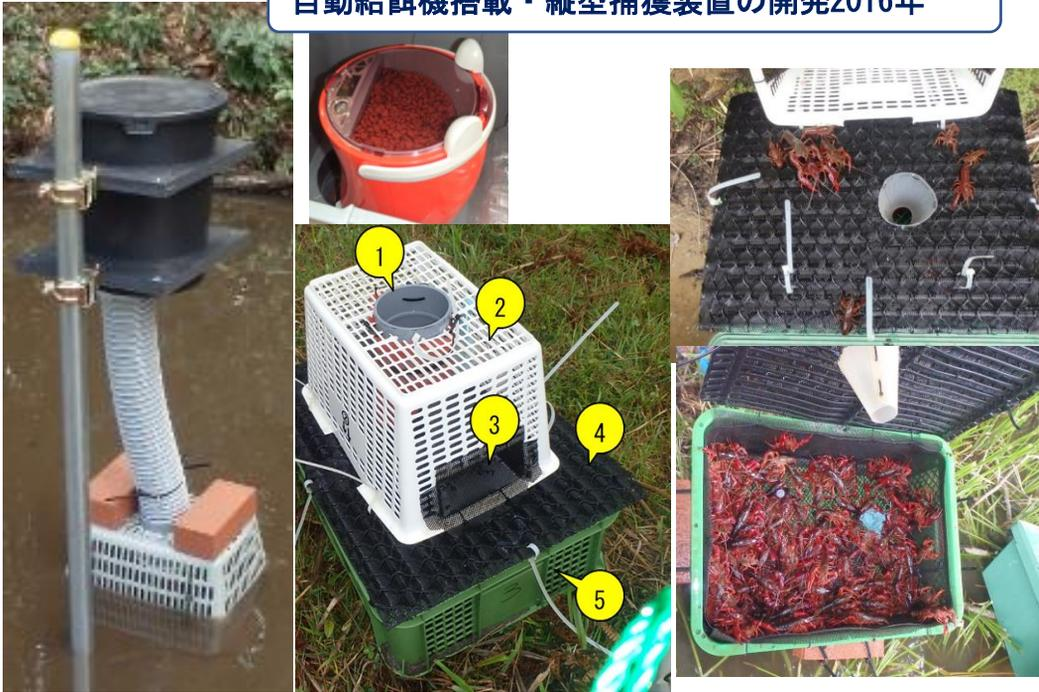
②2019年にコストダウンと深所における利用を可能にするため、自動給餌機を搭載しないタッパーウェア給餌型の連続捕獲装置を開発した。
